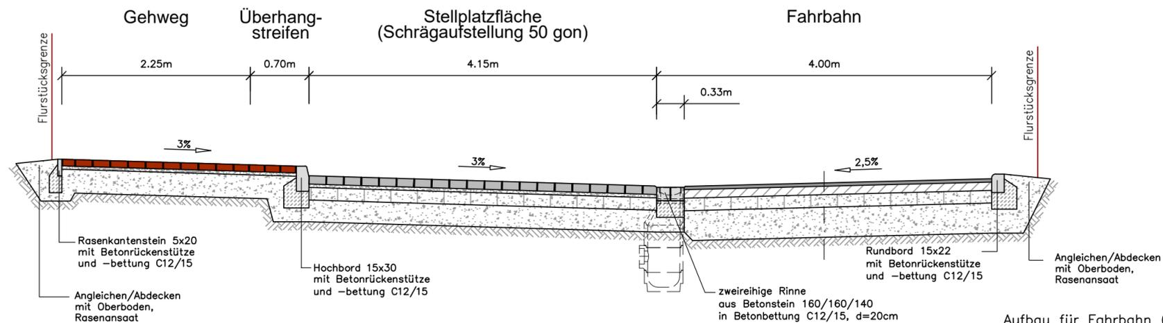
Aufbau für Fahrbahn (TA 1) und Einmündungen nach RStO 12, Tafel 1, Zeile 3:
