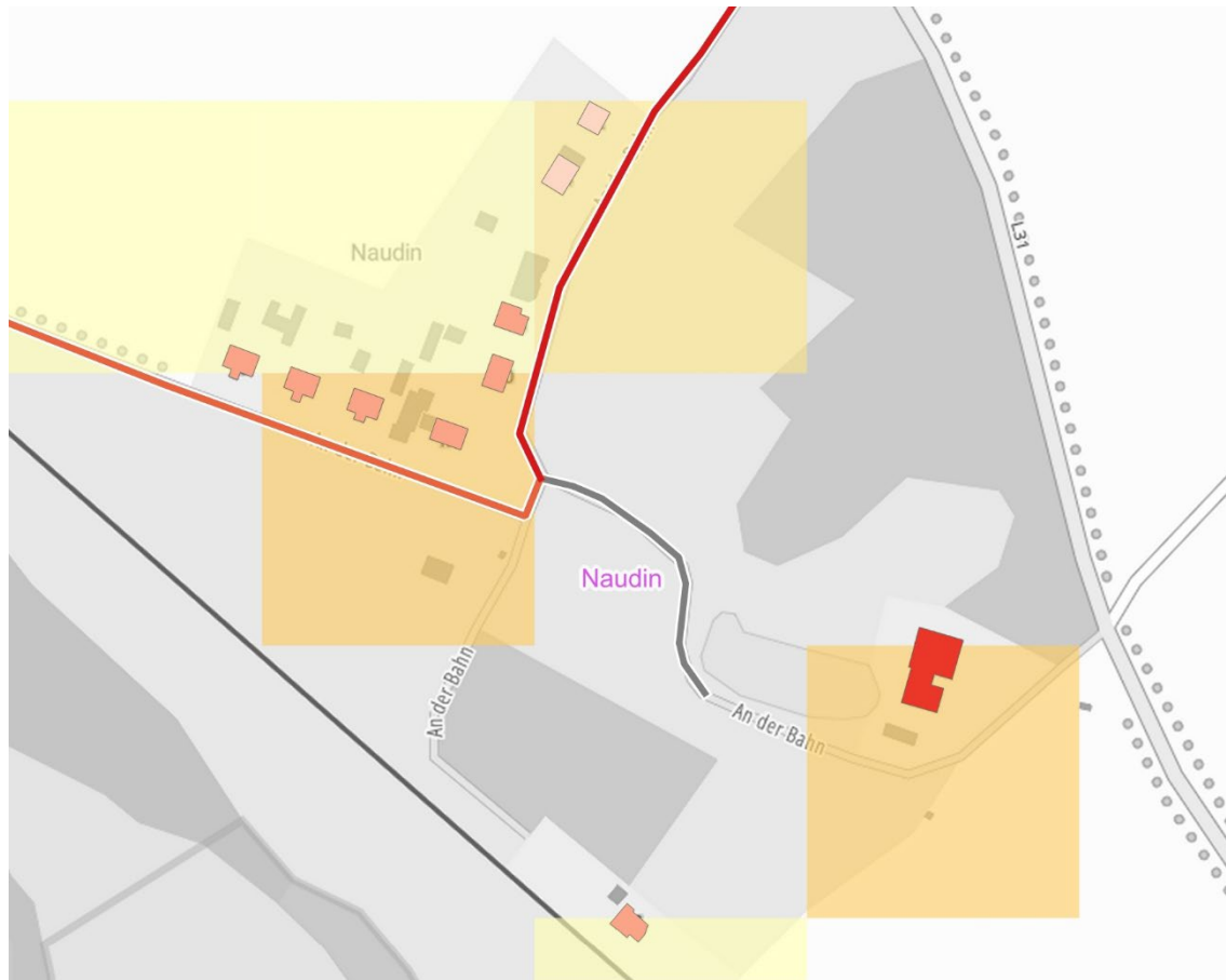
Abbildung 22: Wärmeliniendichte im Ortsteil Naudin
