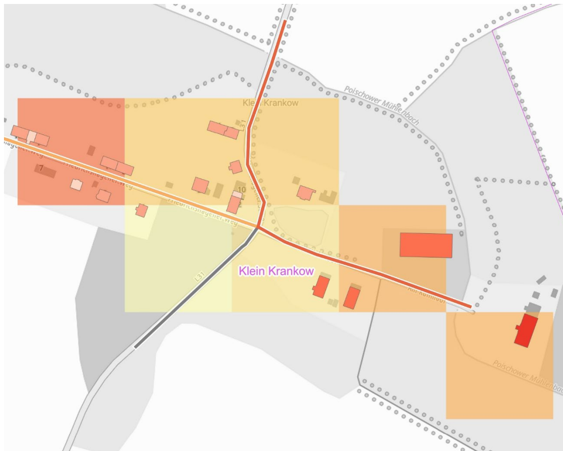
Abbildung 20: Wärmeliniendichte im Ortsteil Klein Krankow
