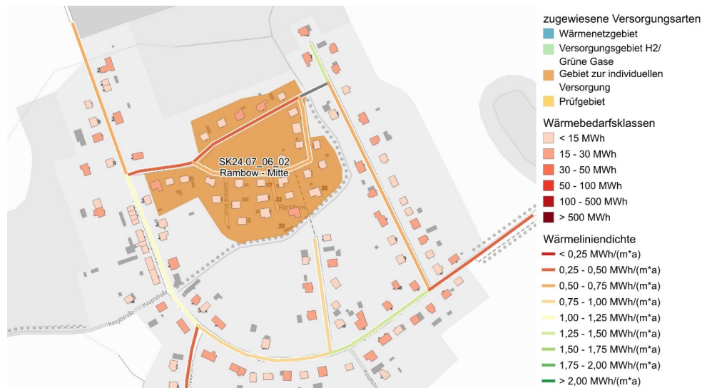
Abbildung 50: Zugeordnete Versorgungsarten für Rambow - Mitte
